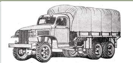
Камион GMC, 2½ t, 6x6, модел CCKW-353 A1/2 (без чекрка) са зашвореном кабином, модел 1608, и обичним сандуком
