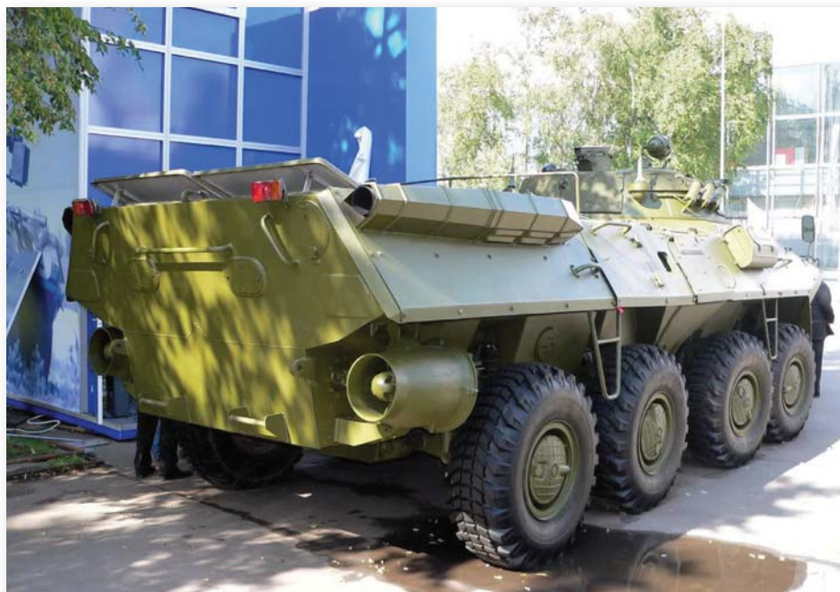
Задња страна са видљивим водомлазним покретачима
