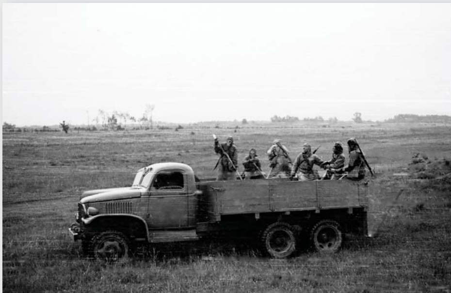
Аутомобил „џемс“ на вежби 1948. године: за задњи део возила постављен је висећи прибор за деконтаминацију земљишта сувим хлорним кречом, набављен из СССР-а. Послуга је ручно избацивала креч кроз ошвор прикључка за расејавање. (Фото-центар „Одбрана“)
