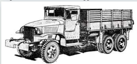
Модел CCKW-353 B1/2 (са чекрком) са ошвореном кабином, модел 1619, и обичним сандуком
