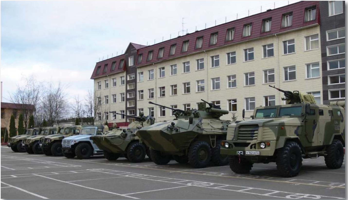
Друго возило са десне стране је БТР-90. Јасно се види знатно веће димензије у односу на БТР-80 (шреће возило здесна)
